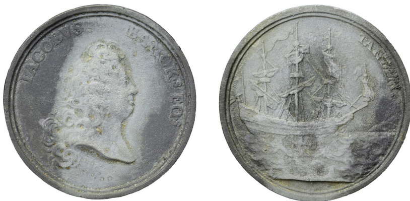
Fig. 4. Medalj med tennpest. Tennpest är resultatet av en naturlig process som startas av kyla. Dessvärre är sönderfallet oåterkalleligt och tennföremål som drabbats kommer fortsätta försämrars. Foto: författaren.
